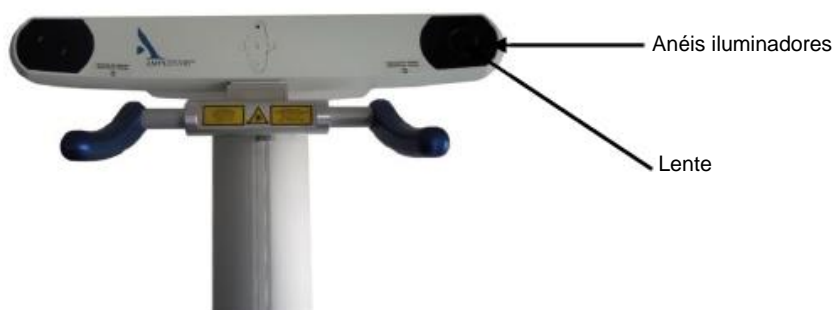
Figura 14: Limpeza dos sensores ópticos
