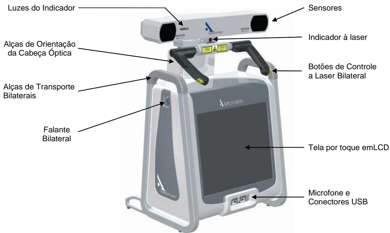
Figura 1: painel frontal da estação tipo 1
