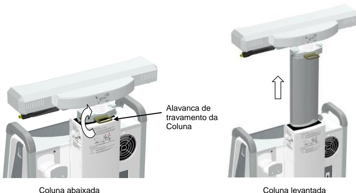
Figura 13: Ajuste da coluna
